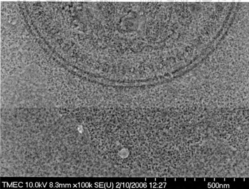
รูปที่ 5.20 ภาพพื้นผิวของชั้นนาโนพอร์สซัลไฟคอน โดยใช้ความหนาแน่นกระแสไฟฟ้า 20 \text{ mA/cm}^2
