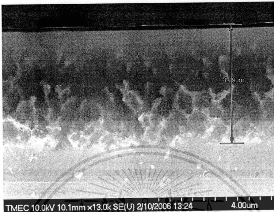
รูปที่ 5.11 ภาพตัดขวางของชั้นพอร์ซซิลิคอน โดยใช้เวลาในการสร้าง 10 นาที
