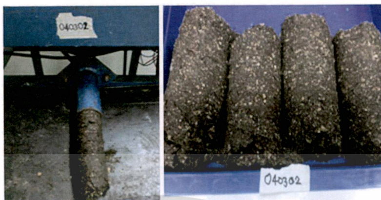
ภาพที่ 4.2 แสดงแท่งเชื้อเพลิงที่ออกมาจากเครื่องอัดของแท่งเชื้อเพลิงที่ได้จากเปลือกเห็ด + แป้ง 10%
