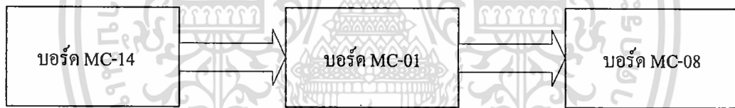
รูปที่ 7.2 การเชื่อมต่อบอร์ดสแต็ปปีงมอเตอร์กับบอร์ดควบคุม
