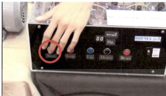
รูปที่ 12 กดปุ่ม Start เพื่อเปิดอินเวอร์เตอร์
