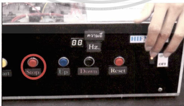
รูปที่ 16 การปิดสวิทช์ไฮบริดจ์อินเวอร์เตอร์
