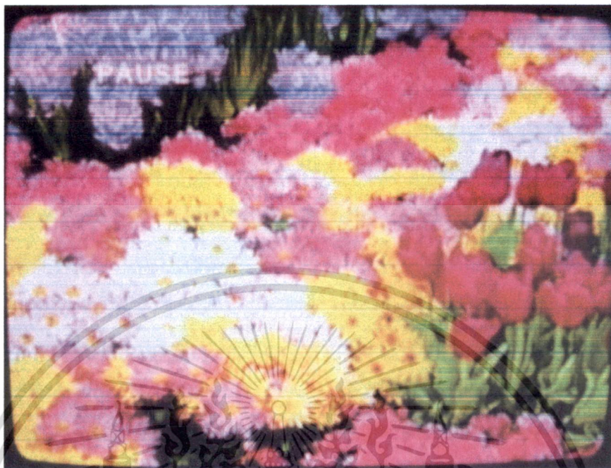
รูปที่ 4.12 ผลกระทบเมื่อเกิดความผิดเพี้ยนทางอัตราขยายที่ +2 dB
