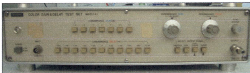
รูปที่ 4.8 เครื่อง Color Gain & Delay Test Set MS 321A
