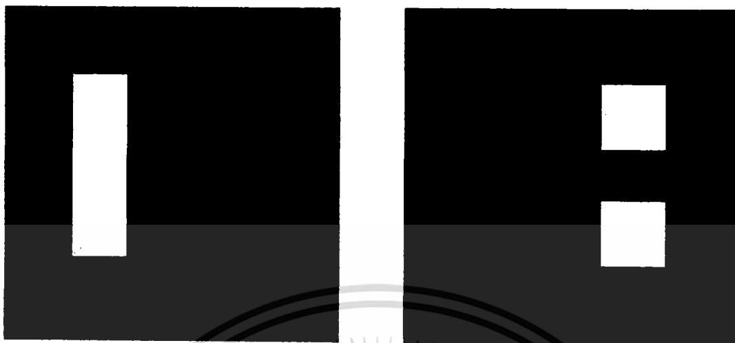
รูปที่ 3.15 มาส์กที่ 1 : Ohmic Mask
