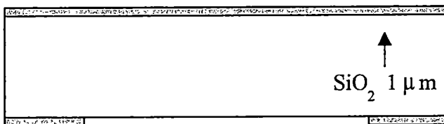
รูปที่ 4.9 ภาพตัดขวางของแผ่นผลึกที่ผ่านขั้นตอนที่ 7
