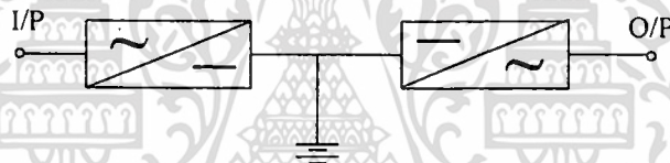
รูปที่ 1.8 โครงสร้างของระบบ UPS แบบต่อเนื่อง
