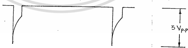
รูปที่ 4.6 แสดงรูปร่างของสัญญาณที่จุดวัดขาเบสของ Q28
