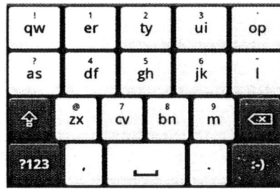
รูปที่ 2.2 แผนผังคีย์บอร์ดแบบ Compact QWERTY
