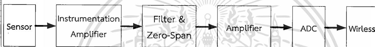
รูปที่ 3.1 ส่วนประกอบต่างๆของวงจรเครื่องวัดสัญญาณคลื่นหัวใจ
