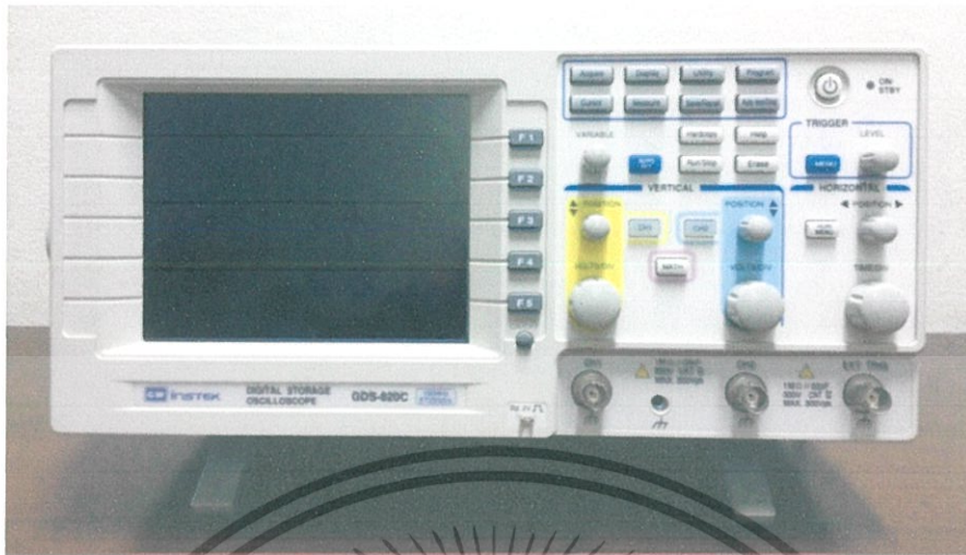
ภาพที่ 4.15 เครื่องออสซิโลสโคป (Oscilloscope)
