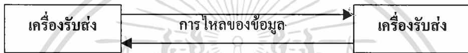
รูปที่ 2.16 รูปแบบการส่งติดต่อสื่อสารข้อมูลแบบอนุกรม
