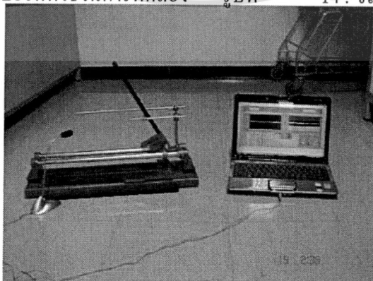
รูปที่ 15 : รูปเครื่องเคาะสับประรดและคอมพิวเตอร์ที่ติดตั้งโปรแกรม LabView ในการทดลอง
