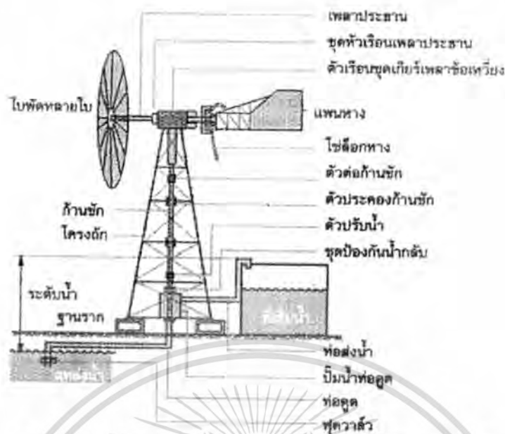
รูปที่ 2.18 ส่วนประกอบที่สำคัญของกังหันลมแบบสูบน้ำชักเพื่อสูบน้ำ
