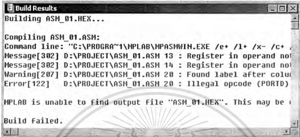
รูปที่ 1.5 แสดงหน้าต่างเมื่อการแอสเซมเบลอร์เกิดความผิดพลาด
