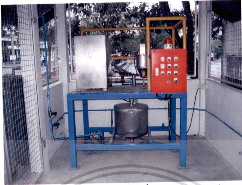
รูปที่ 3.18 ต้นแบบและระบบทำความอากาศที่ได้ปรับปรุงใหม่ด้วยการป้อนผสม ประยุกต์จากเทคโนโลยีหุ่นยนต์อลวน
