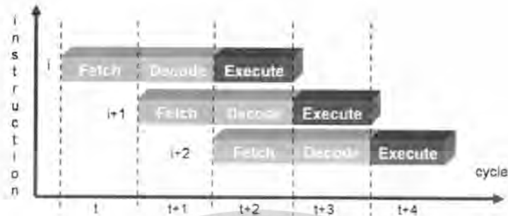
ภาพที่ 5.16 แสดงกระบวนการทำงานของไปป์ไลน์ใน ARM7 โปรเซสเซอร์
