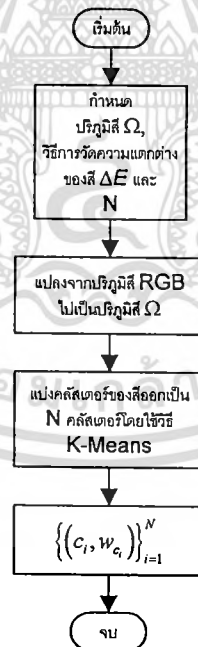
รูปที่ 14. Flowchart การทำงานของโปรแกรม VqKmeanCalculate
