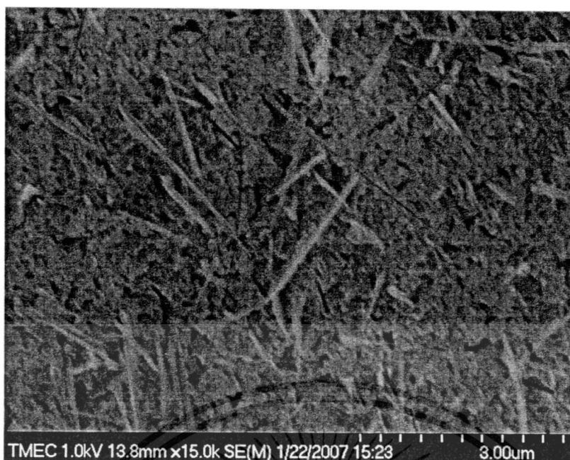
รูปที่ 4.14 แสดงเส้นลวดนาโนคอปเปอร์ออกไซด์ที่ได้จากการเผาในสถานะออกซิเจน อุณหภูมิ 550 องศาเซลเซียส เป็นเวลา 30 นาที
