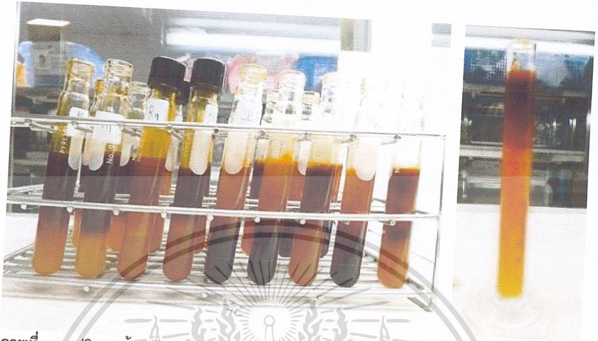
ภาพที่ 4.28 ปริมาณน้ำมันไบโอดีเซล (ด้านบนของหลอด) และกลีเซอริน (ด้านล่างของหลอด) ที่ผลิตได้ที่ระดับความเข้มข้นต่างแตกต่างกัน
