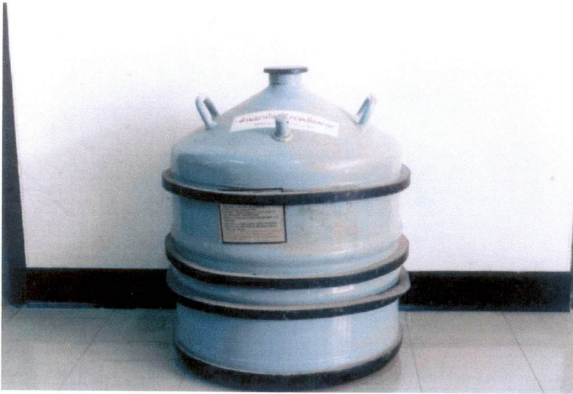
ภาพผนวกที่ 3 ถังเก็บไนโตรเจนเหลวที่ใช้เก็บชิ้นส่วน
