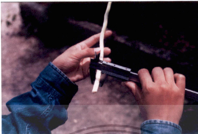
ภาพภาคผนวกที่ 7 แสดงการวัดขนาดเส้นผ่าศูนย์กลางลำต้นด้วยเวอร์เนียคาลิเปอร์
