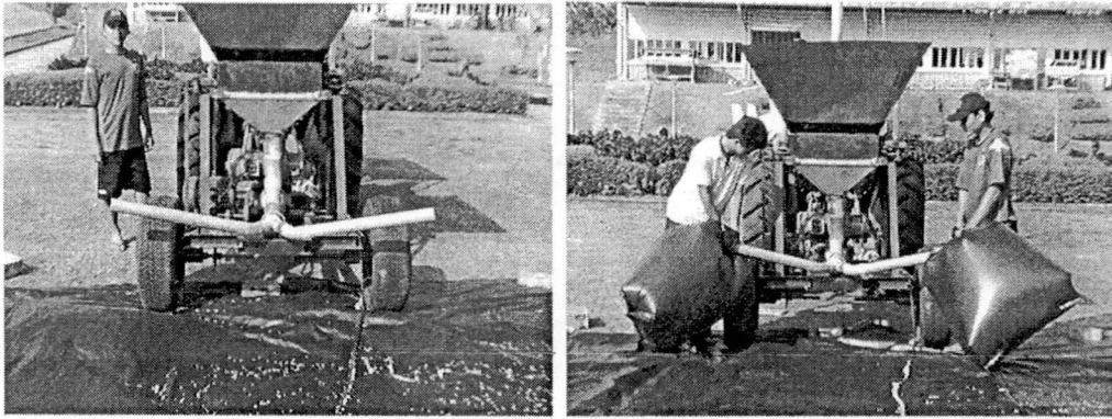
รูปที่ 4.2 ทดสอบปริมาณการจ่ายปุ๋ยที่ออกจากปลายท่อทั้งสอง
