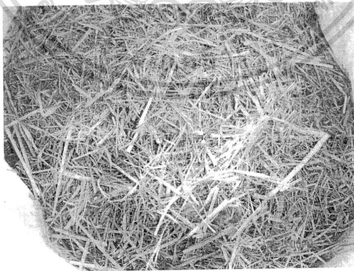
ภาพที่ 4.8 ฟางที่ตัดออกมาจากเครื่องหั่นย่อย ที่ความเร็วรอบใบมีด 700 รอบ/นาที เอกสารนี้เป็นเอกสารที่สงวนไว้สำหรับการใช้งานเพื่อการศึกษาเท่านั้น ไม่อนุญาตให้นำไปใช้ประโยชน์ด้านการค้า ไม่ว่ากรณีใดๆทั้งสิ้น อีกทั้งห้ามมิให้ดัดแปลงเนื้อหา และต้องอ้างอิงถึงเจ้าของเอกสารทุกครั้งที่มีการนำไปใช้
