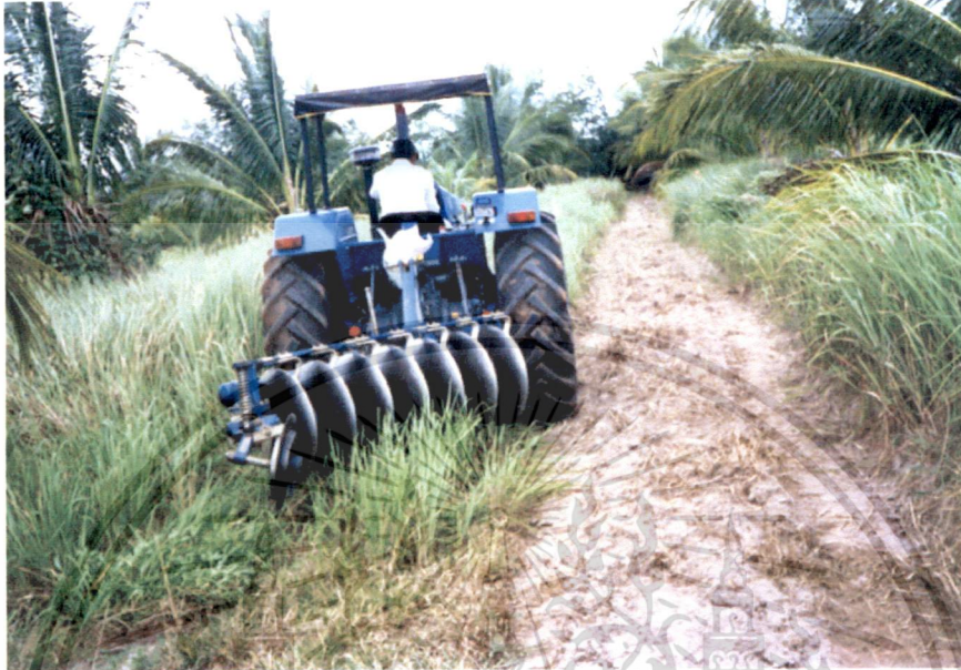
ไถพรวนเจ็ดที่ใช้ไถเตรียมพื้นที่และใช้กำจัดหญ้าคาในแปลงวิจัย
