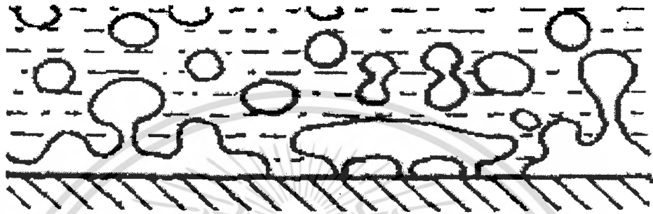
ภาพที่ 3.11 ลักษณะของ Pool boiling ในช่วงของ Transition boiling [12]
