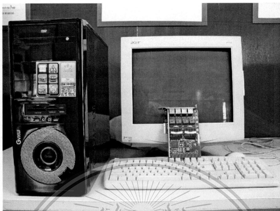
ภาพที่ 3.2 เครื่องคอมพิวเตอร์และแผงวงจรต่อเชื่อมกับกล้องความเร็วสูง
