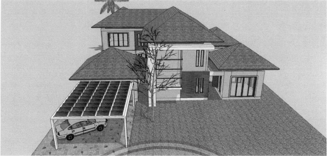
ภาพที่ 5.8 แสดงบ้านสองชั้นใช้แผงโซลาร์เซลล์ที่หลังคาที่จอดรถ
