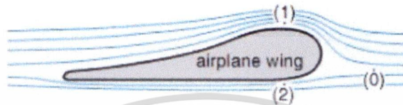
รูปที่ 2.10 กระแสอากาศที่ไหลผ่านปีกเครื่องบิน [7]
