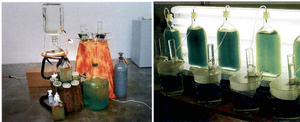
รูปที่ 2.7 การผลิตก๊าซไฮโดรเจนจากสาหร่ายสีเขียว ที่มา : http://www.futurefarmers.com/survey/algae.php
