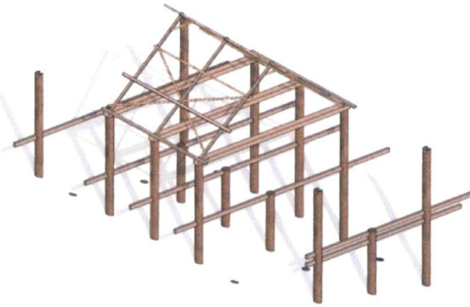
7. วางไม้ขวางยึดจันทันและวางไต้ยงลมกากบาท ทะแยงมุมยึดจันทัน
