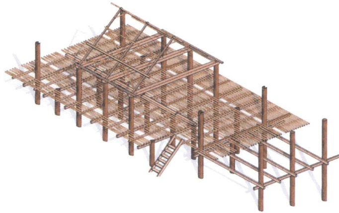
10. วางท่อนไม้ไผ่รับพื้นฟากตลอดเรือน พาดบันได
