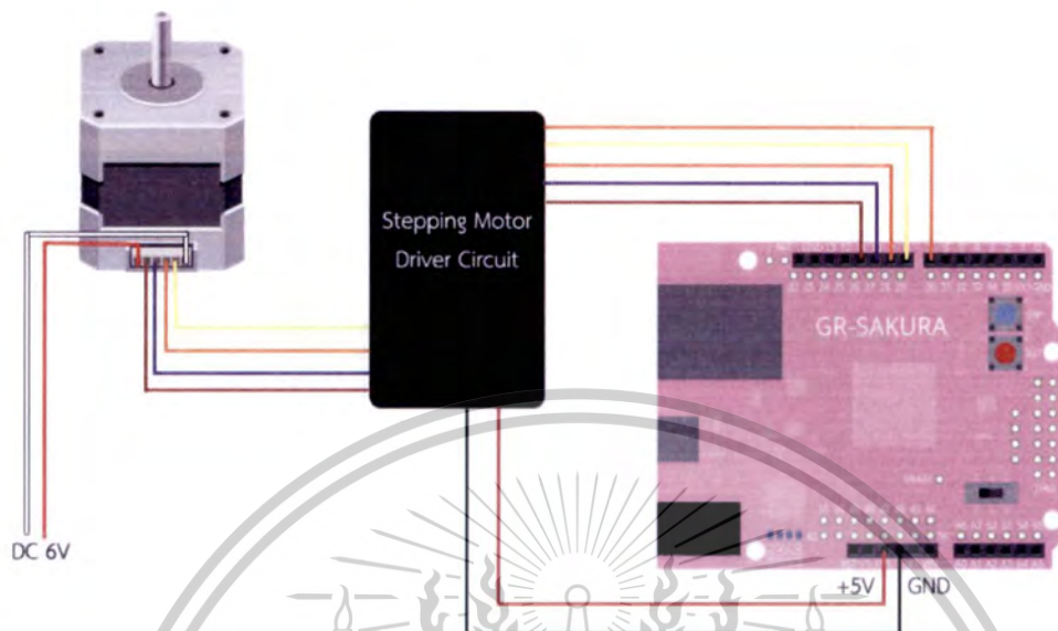
ภาพที่ 3.23 การเชื่อมต่อ GR-SAKURA Board กับ Stepping Motor
