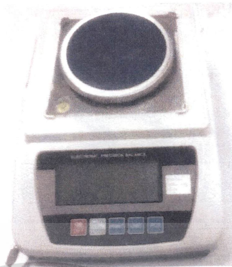
ภาพที่ 3.12 เครื่องชั่งดิจิทัล ทศนิยม 3 ตำแหน่ง
