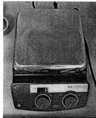
เครื่องกวนสารโดยใช้แท่งแม่เหล็ก (Magnetic Stirrer)
