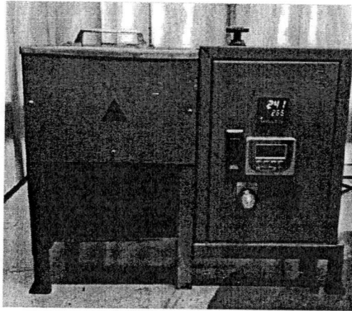
รูปที่ 3.8 เครื่องทดสอบอัตราการไหลของพลาสติก
