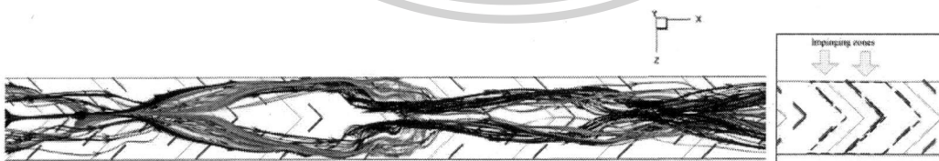
รูปที่ 4.5 เส้นกระแสการไหลตามแนวยาวระหว่างรอยต่อของโมดูลและระหว่างแถวของคريب สำหรับของแผ่นกั้นตัววีแยกตัวที่ค่า Re = 600 , PR = 1 และ BR = 0.15
