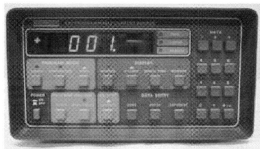
รูป 2.20 แสดง Constant Current Source ที่มา: วตาพร ทิลาพตะ (2553). การพัฒนาระบบการวัดเอกสารนี้เป็นเอกสารที่สงวนไว้สำหรับการใช้งานเพื่อการศึกษาเท่านั้น ไม่อนุญาตให้นำไปใช้ประโยชน์ด้านการค้า สมบัติของสารกึ่งตัวนำด้วย 4-Point Probe, หน้า 22 ไม่ว่ากรณีใดๆทั้งสิ้น อีกทั้งห้ามมิให้ตัดแปลงเนื้อหา และต้องอ้างอิงถึงเจ้าของเอกสารทุกครั้งที่มีการนำไปใช้
