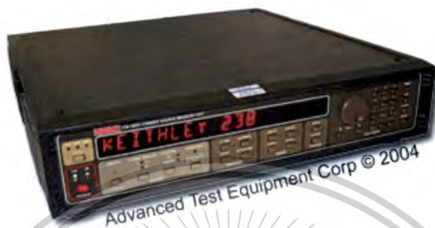
รูปที่ 3.10 เครื่องวัดค่าความสัมพันธ์ของกระแสและความต่างศักย์ของโครงสร้างที่ประดิษฐ์ขึ้น (Keithley 238)
