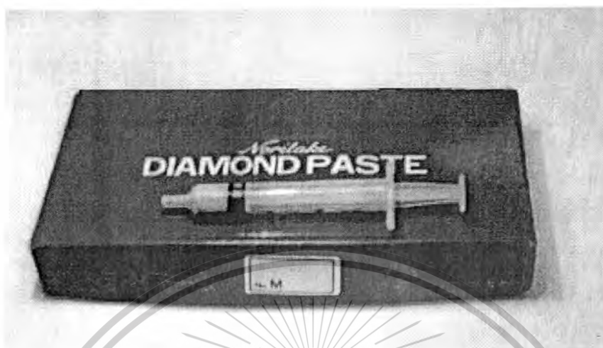
รูปที่ 3.1 ครีมเพชรที่ใช้ในการขัดผิวหน้าฐานรองซิลิกอนขนาดเมล็ดผลึก 0.25 ไมครอน
