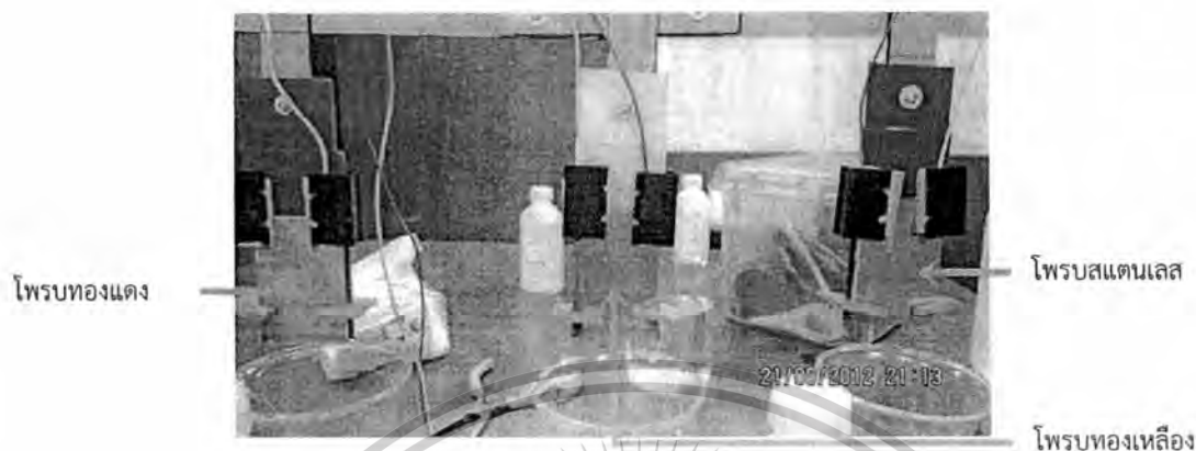
รูปที่ 3.11 แสดงลักษณะของโพรบที่ใช้ในการทดลอง
