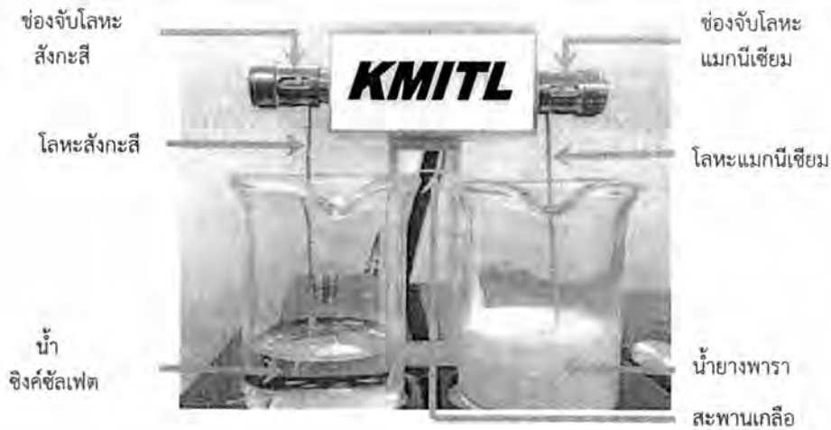
(ข) แสดงตำแหน่งต่างๆของโพรบขณะทำการตรวจวัดแมกนีเซียม
