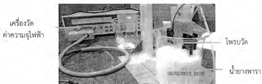
รูปที่ 4.16 แสดงการตรวจวัดด้วยโพรบวัดความจุไฟฟ้าในน้ำยวงพารา 30%
