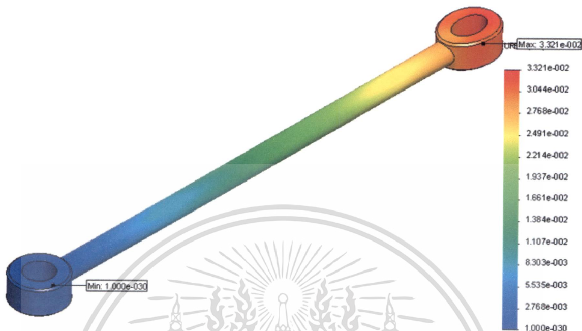
ภาพที่ 4.11 ค่าความเค้นตัวที่จุดต่างๆเมื่อชิ้นส่วนต่อโยงได้รับแรงดึง
