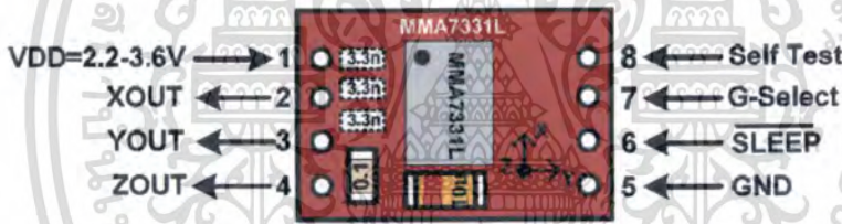
ภาพที่ 4.2 โครงสร้างตัวตรวจจับความเร่งแบบสามแกน (ยี่ห้อ Freescale รุ่น MMA7331)
