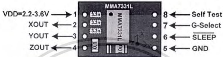
ภาพที่ 4.2 โครงสร้างตัวตรวจจับความเร่งแบบสามแกน (ยี่ห้อ Freescale รุ่น MMA7361)
