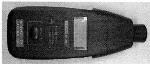
ภาพที่ 5.30 เครื่องวัดความเร็วรอบ (tachometer) ยี่ห้อ Digicon รุ่น DT-245P
