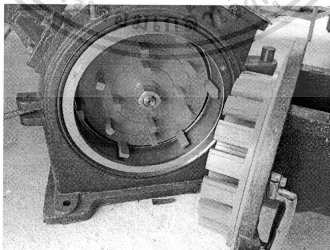
ภาพที่ 4.31 แสดงลักษณะภายในเครื่องบด ยี่ห้อ BONNY รุ่น YPT-302 (F/S)
