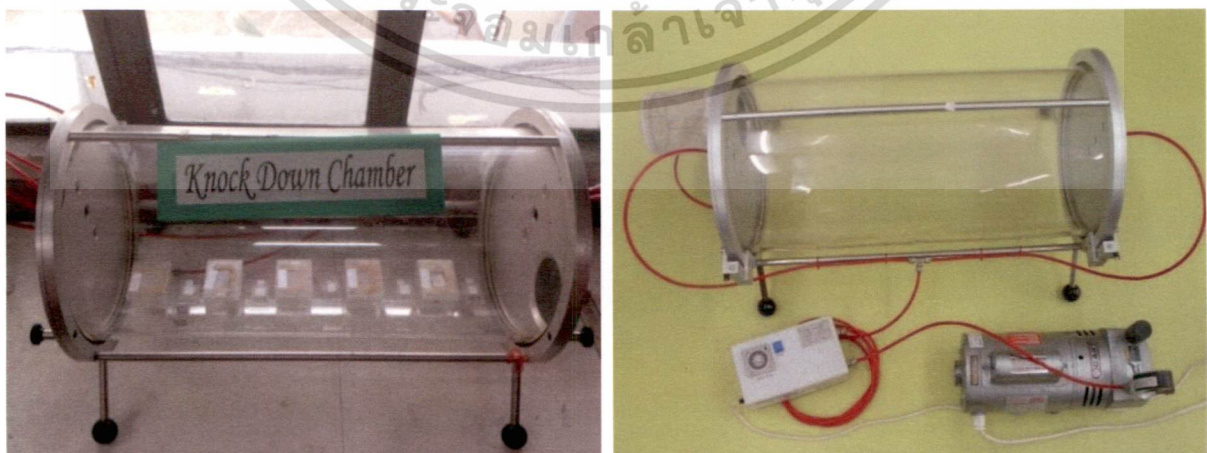
ภาพที่ 2.4 การทดสอบโดยวิธีการรมในเครื่อง knockdown chamber
