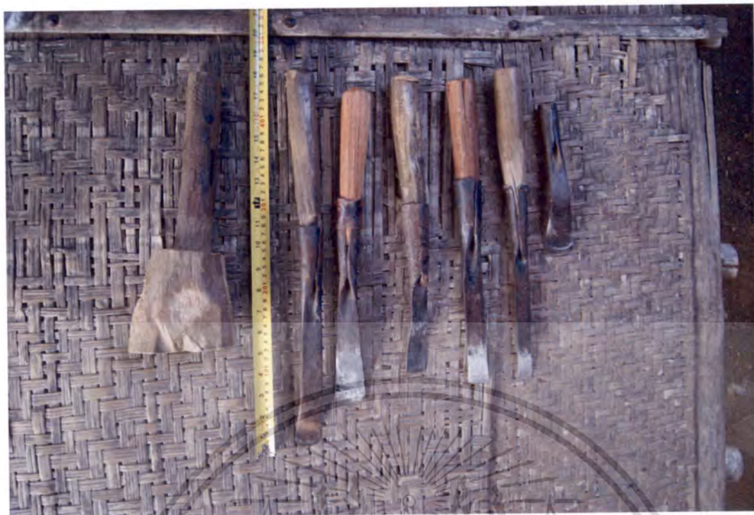
ภาพที่ 4.9 แสดงเครื่องมือตักแต่งงานไม้ ประเภท สิว (ภาพถ่ายจาก ชุมชนไทลื้อ บ้าน ศิลาแลง อ.ป่า)
