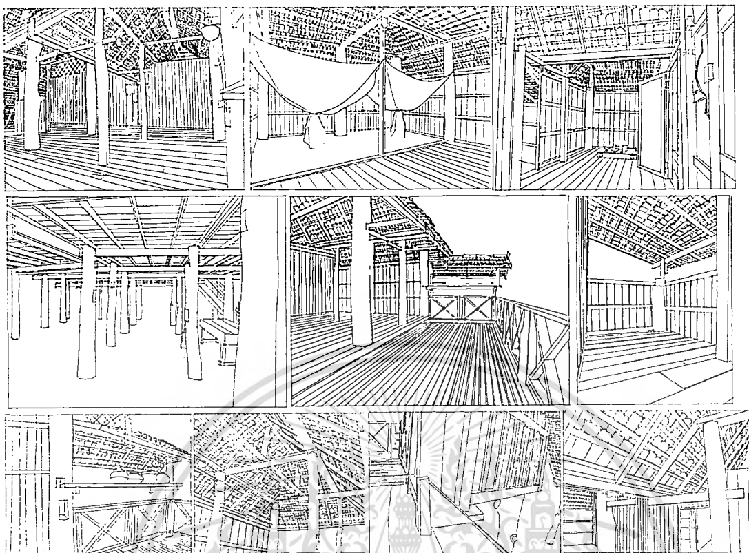
ภาพที่ 5.23 แสดงภาพลายเส้น ในเรือนและส่วนโครงสร้างรวมถึงรายละเอียดของการเข้าไม้ของเรือนอนุรักษ์ไทลื้อ บ้านหนองบัว ต.ป่าคา อ.ท่าวังผา เรือนโฮมสเตย์ (ลายเส้นโดย นายธนพล หนูมา , น.ส. วาสนิ ชมโฉม , น.ส. นันทวัน แก้วเผือก)
