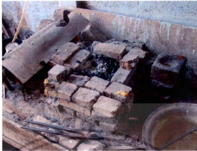
ภาพที่ 4.86 แสดงลักษณะเตาเผาที่ประกอบขึ้นเอง ที่มา : ภาพถ่ายลักษณะเตาเผาที่บ้าน คุณบุญช่วย หิรัญวิทย์
