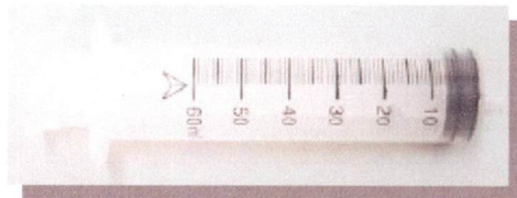
รูปที่ 2.2 แสดงกระบอกฉีดยาปริมาตร 60 ml ที่ดัดแปลงเป็นอุปกรณ์เก็บตัวอย่าง
